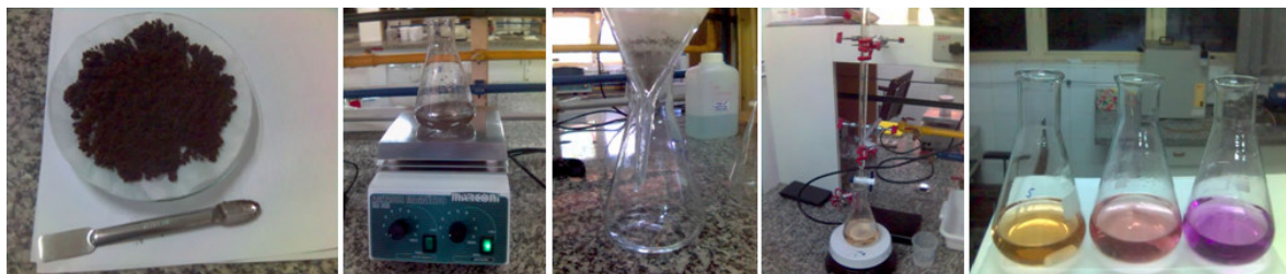
Figura 1. Seqüência das etapas realizadas em experimentos para a determinação do tempo de contato dinâmico e capacidade máxima de adsorção Cu(II) por raízes de aguapé.
